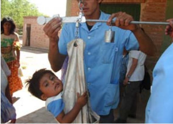
**Balanzas tipo pilón:** Cuando se detecta error en el peso se deberá calibrar con un herrero
